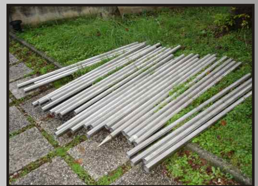
Figura 5: particolari della sonda geotermica
